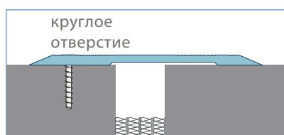
CS с односторонним креплением
